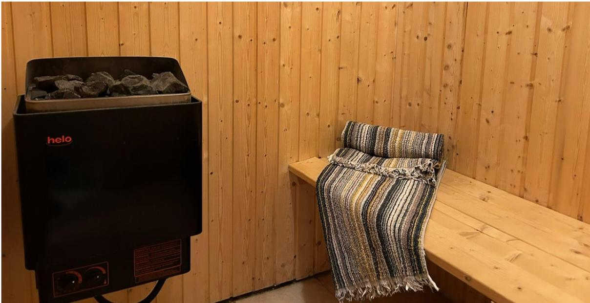
Decken Sie den Saunaofen niemals ab und vermeiden Sie es, Wasser auf den Ofen zu gießen. Dies ist eine Trockensauna. Direktes Wasser auf den Ofen kann ihn zum Platzen und damit zur Zerstörung bringen.
